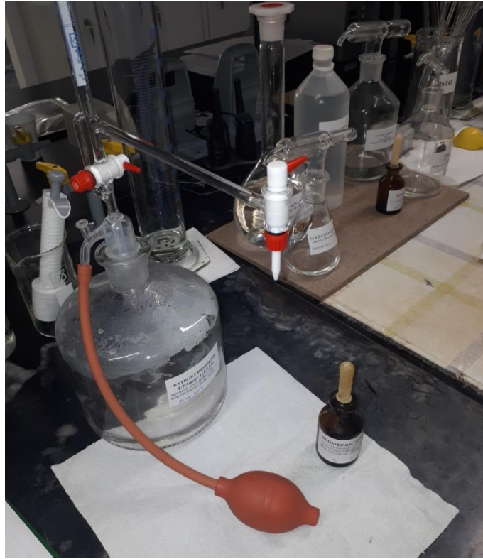
Slika 10. Određivanje ukupnih kiselina u moštu titracijom
