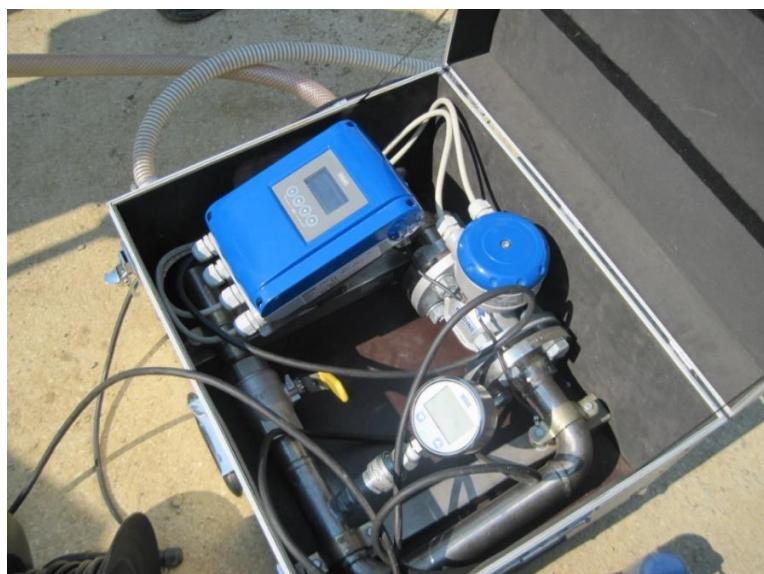
Slika 8. Elektromagnetski mjerač protoka crpke – Volos 2
