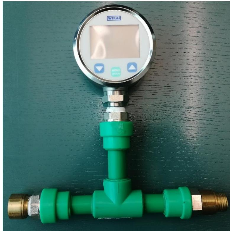
Slika 10. Kontrolni digitalni manometar s nosačem mlaznica
