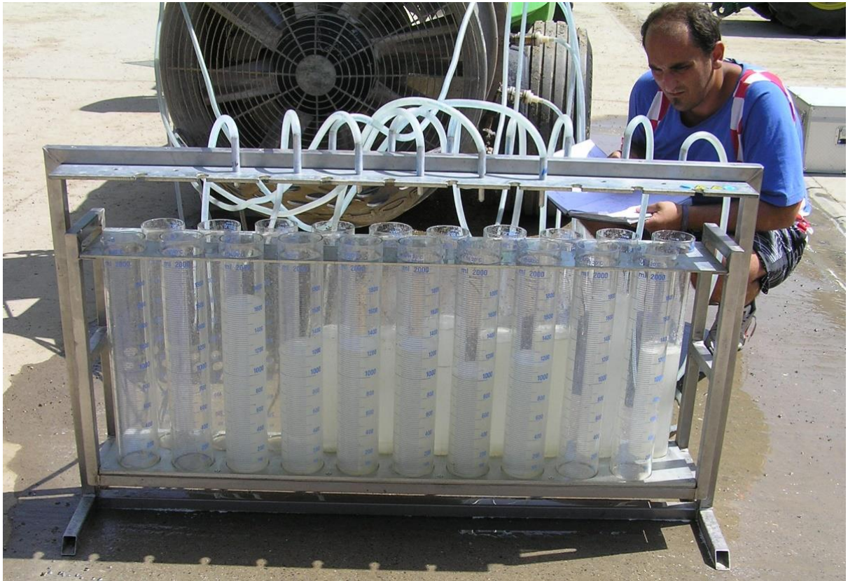
Slika 11. Mjerenje i očitavanje volumnog protoka mlaznica
