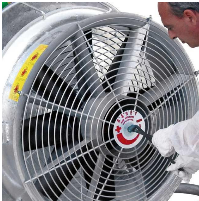
Slika 7. Ventilatorski sustav raspršivača Tifone VENTO - 1000
