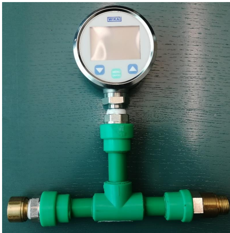
Slika 10. Kontrolni digitalni manometar s nosačem mlaznice
