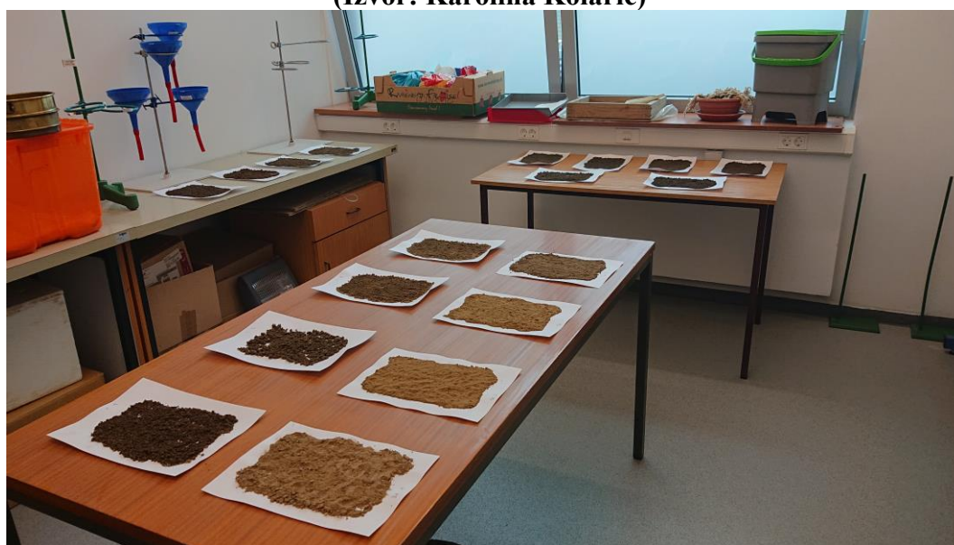
Slika 11. Sušenje izdvojenih uzoraka tla (Izvor: Karolina Kolarić)
