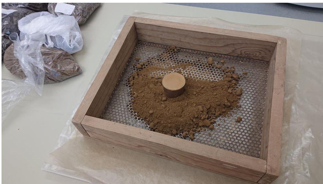
Slika 10. Usitnjavanje uzoraka tla gumenim čepom, prije sušenja (Izvor: Karolina Kolarić)
