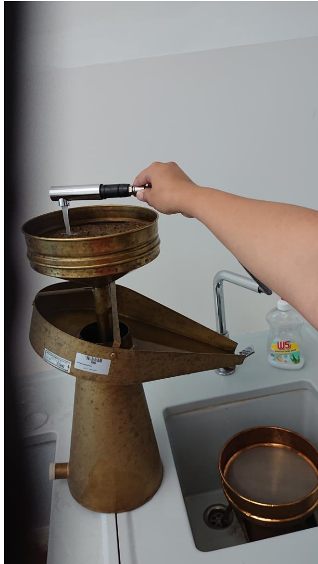
Slika 12. Ispiranje uzoraka tla Fenwickovim aparatom
