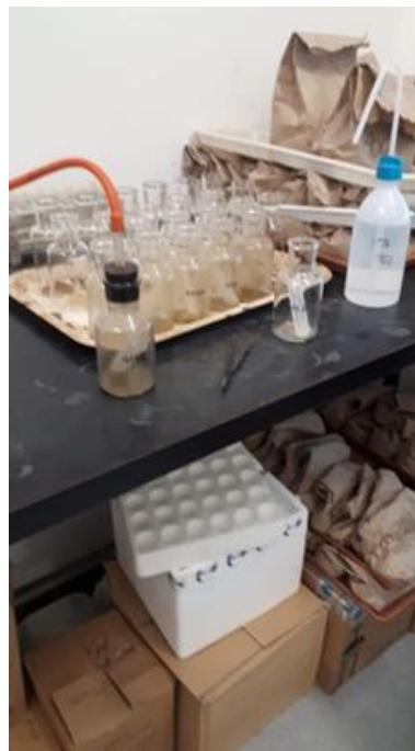
Slika 3.10. Volumetrijska metoda određivanja karbonata (Izvor:Doris Doljanac)
