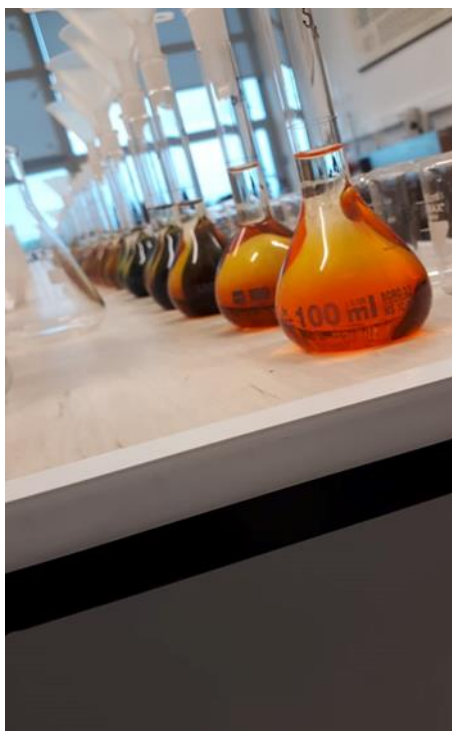
Slika 3.7. Određivanje organske tvari bikromatnom metodom (Izvor:Doris Doljanac)
