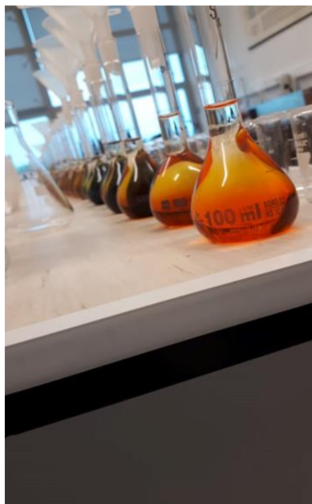
Slika 3.7. Određivanje organske tvari bikromatnom metodom (Izvor:Doris Doljanac)
