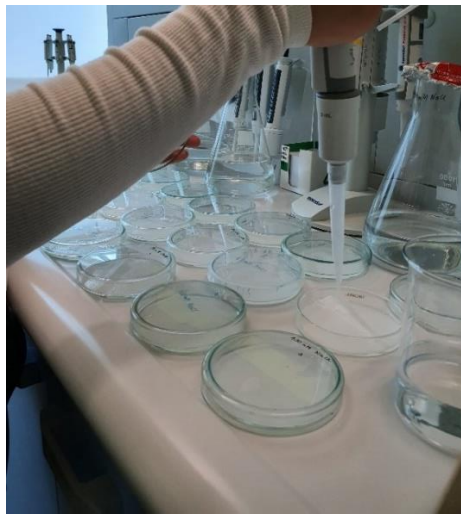
Slika 5. Dodavanje pipetom otopinu na filter papir, original autor Dora Majer
