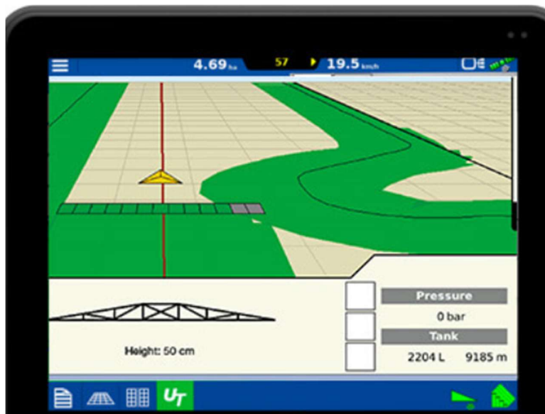
Slika 9. AutoSectionControl za automatsko otvaranje i zatvaranje mlaznica
