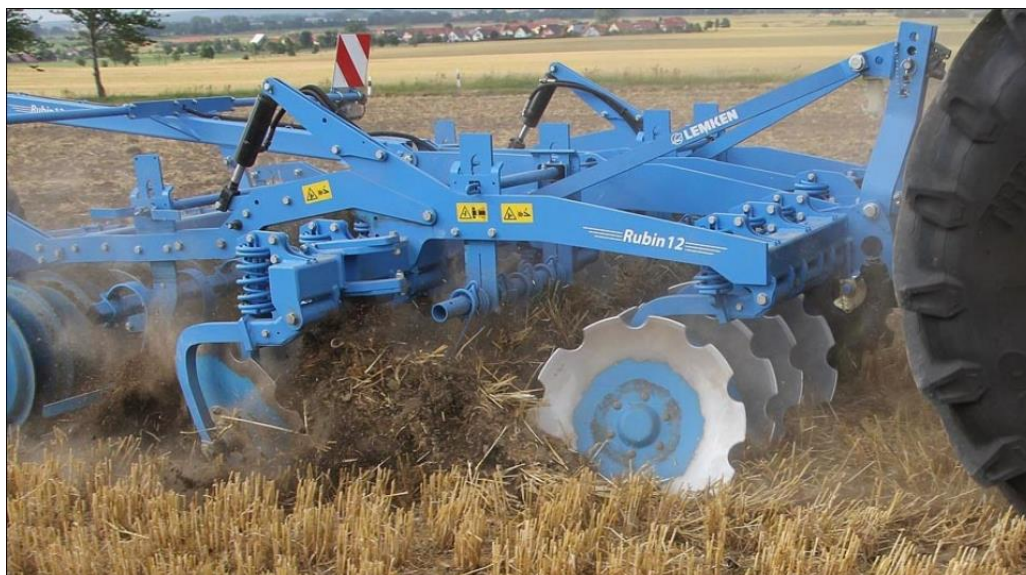
Slika 6. Kratke tanjurače Lemken (Izvor: http://www.profiland.hr/hr/prodajni-program/item/63-kratke-tanjurace )
