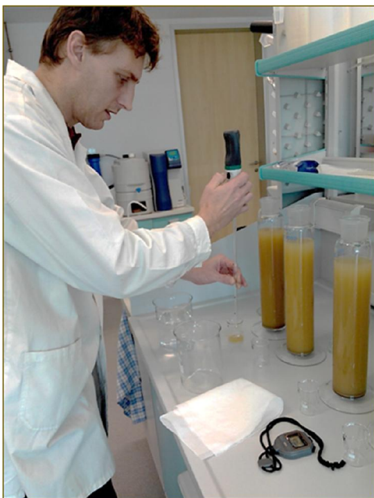
Slika 7. Pipetiranje frakcije gline (orig.)
