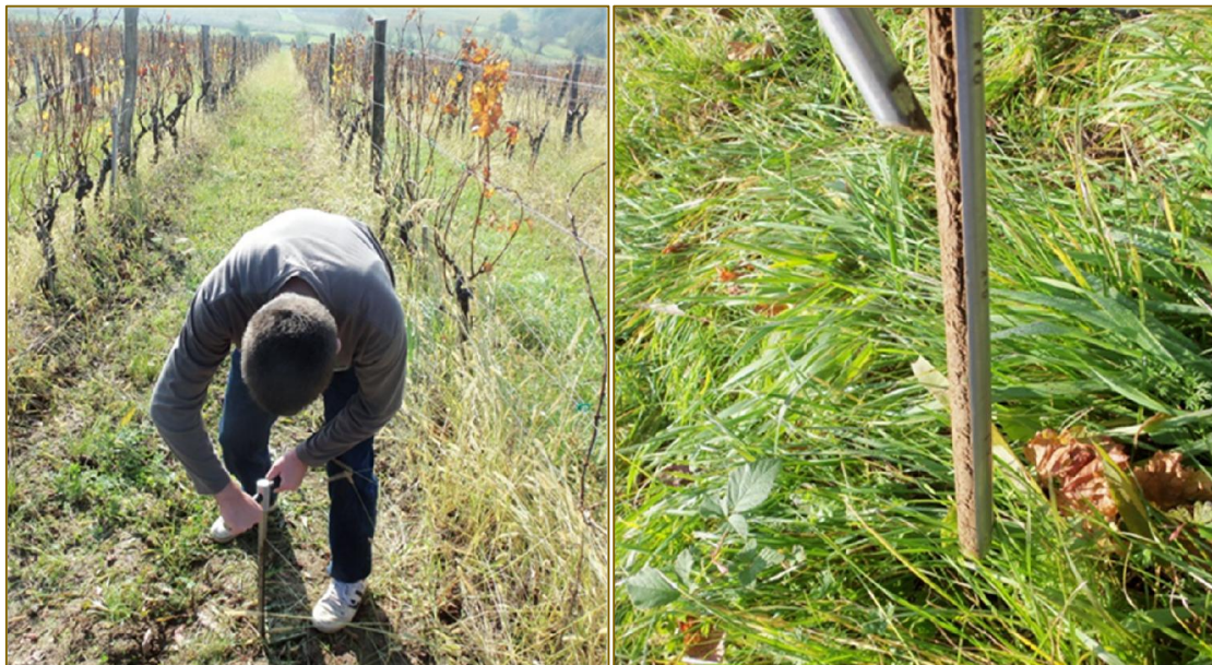
Slika 5. Uzorkovanje tla agrokemijskom sondom (orig.)
