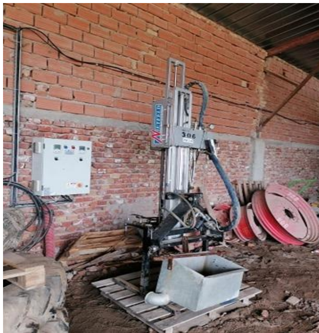
Slika 4. Sonda za uzimanje uzoraka tla (Izvor: Vlastita fotografija)
