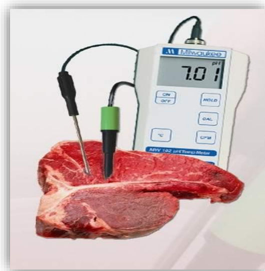
Slika 6. Mjerna sonda za mjerenje pH vrijednosti mesa
