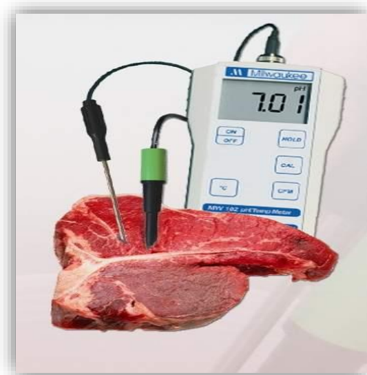
Slika 6. Mjerna sonda za mjerenje pH vrijednosti mesa
