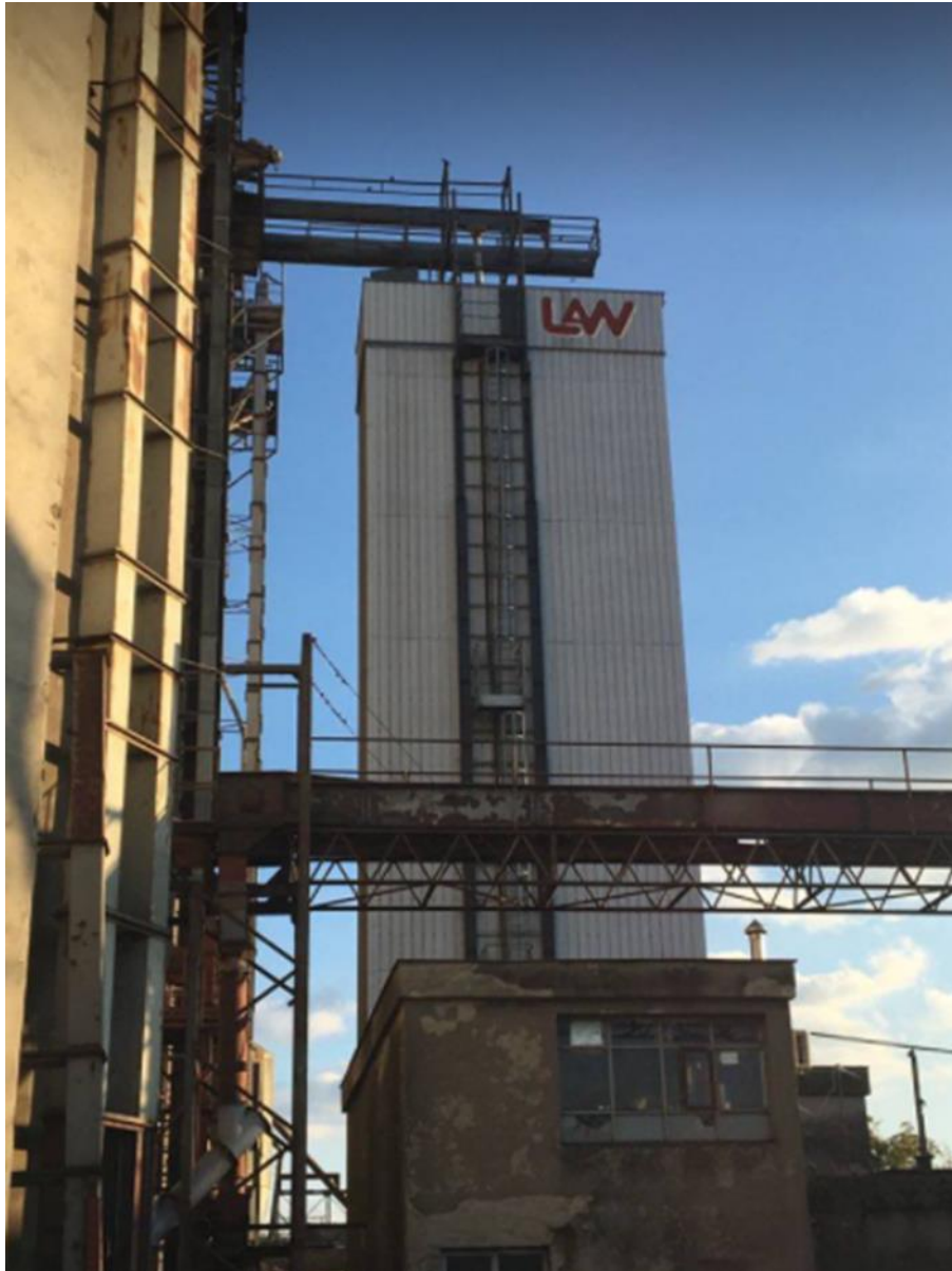
Slika 12. Sušara „LAW SBC 25 LE“ u silosu DARDA (vlastita fotografija)
