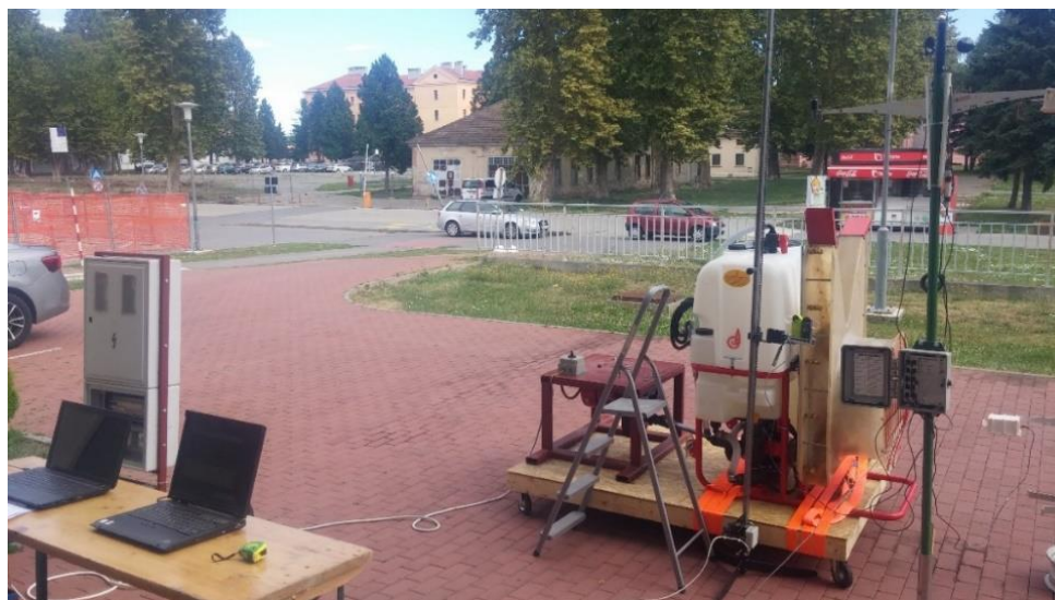
Slika 11. Mjerenje vertikalne raspodjele zračne struje s pripadajućom opremom.
