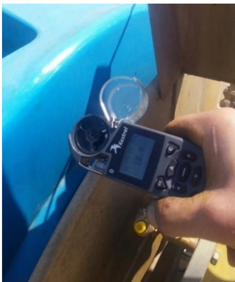
Slika 10. Mjerenje brzine zraka anemometrom Kestrel 4500 BT
