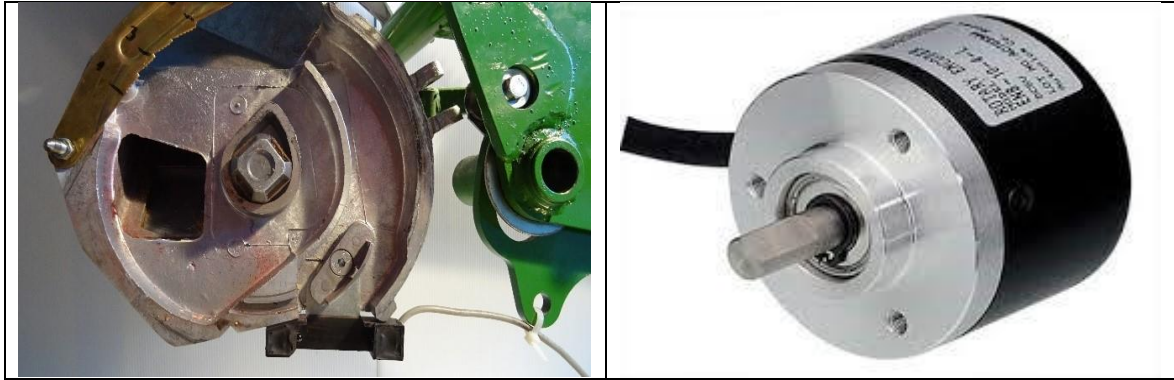
Slika 3. Senzor prolaza zrna (lijevo) i enkoder 1200 za praćenje položaja sijačice (desno)
