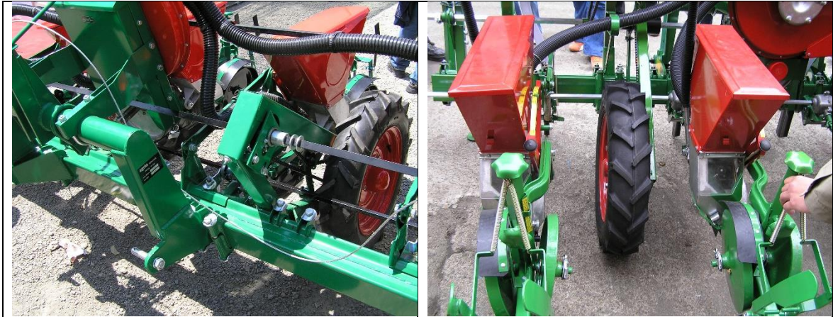
Slika 11. Mjenjačka kutija (lijevo) i pogon od voznog kotača (z32) prema gornjem vratilu (z24) lančanim prijenosom (desno)
