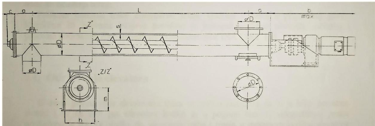
Slika 17. Mjerna shema pužnog transportera „PTC“
