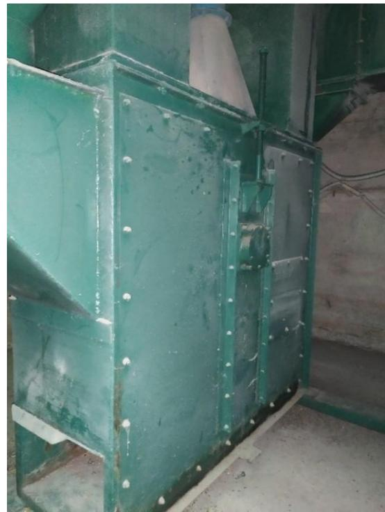
Slika 9. Podnožje elevatorske cijevi
