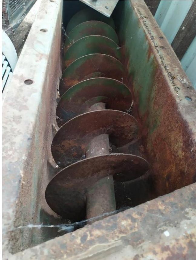
Slika 16. Spirala (zavojnica) pužnog transportera PTC (Izvor: Vlastita fotografija)
