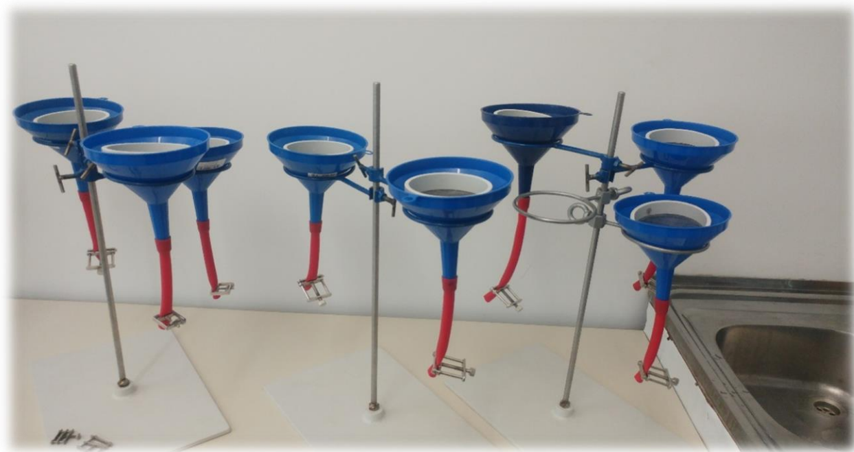
Slika 9. Lijeveći za izdvajanje nematoda Baermannovom metodom
