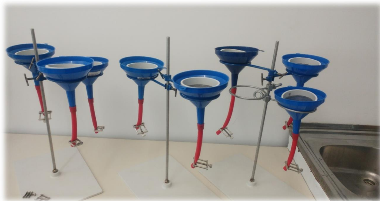
Slika 9. Lijeveći za izdvajanje nematoda Baermannovom metodom
