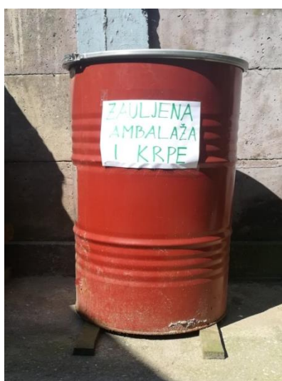
Slika 15. Limena bačva za zauljenu ambalažu i krpe (Izvor: vlastita fotografija)
