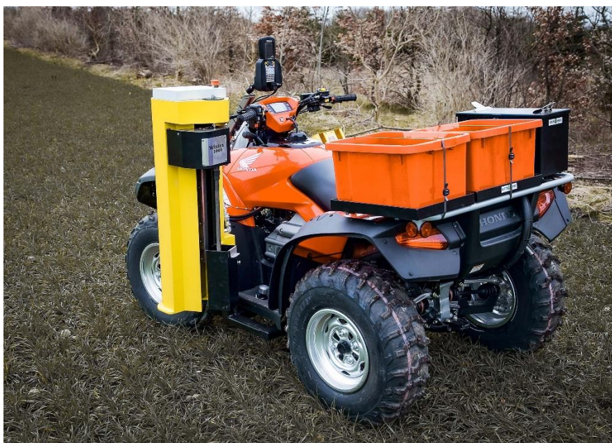
Slika 4. Vozilo opremljeno uređajem za uzimanje uzoraka
