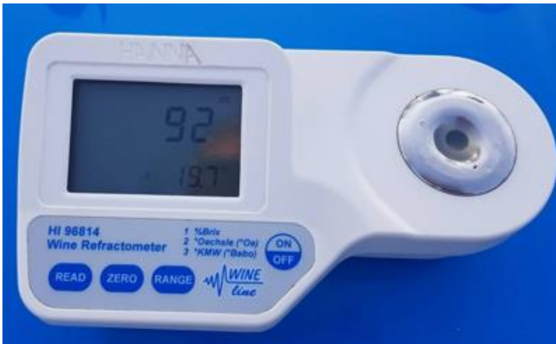
Slika 5. Analiza sadržaja šećera u moštu, digitalni refraktometar (Izvor: F. Klanac)
