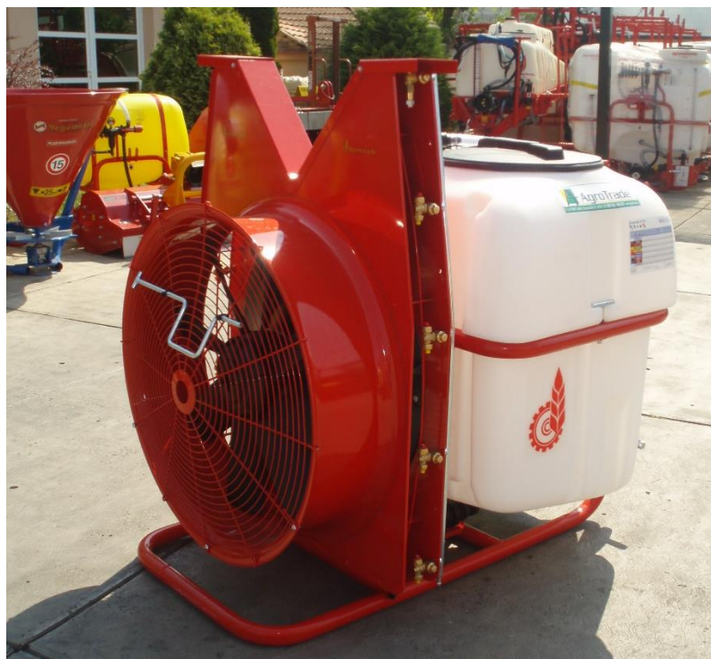
Slika 13. Nošeni raspršivač Agromehanika ENU 200
