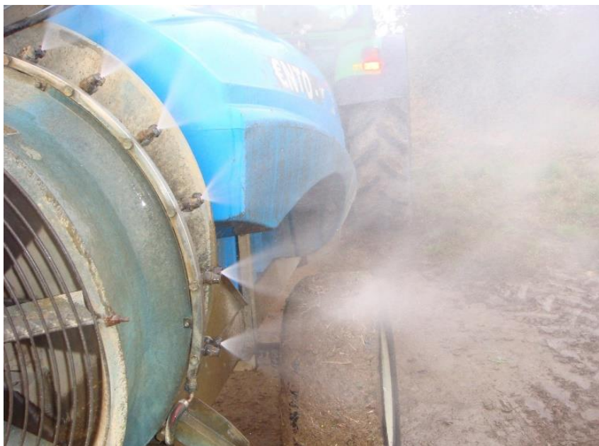
Slika 8. Postupak dezintegracije tekućine
