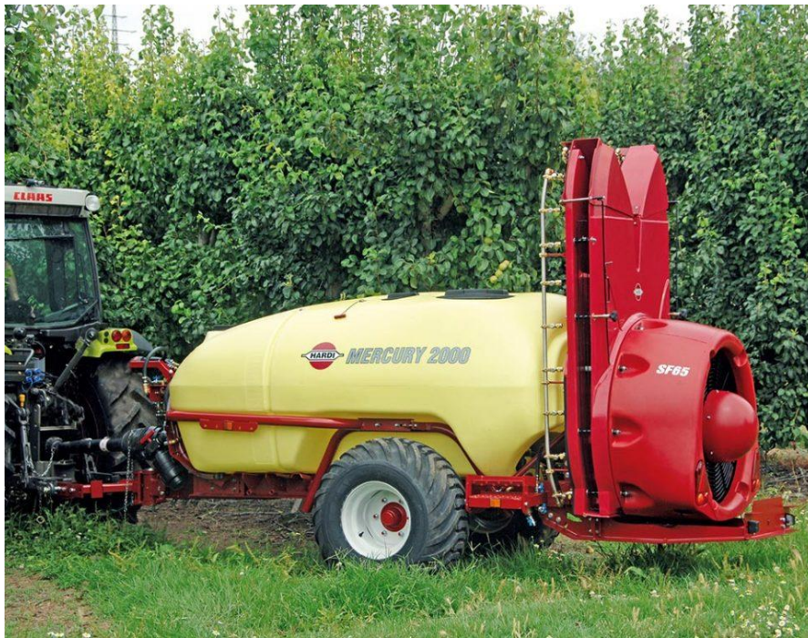
Slika 11. Vučeni traktorski raspršivač tvrtke Hardi (Izvor: https://findri.hr/ponuda/hardi-centrifugalni-ventilator-vuceni/ )
