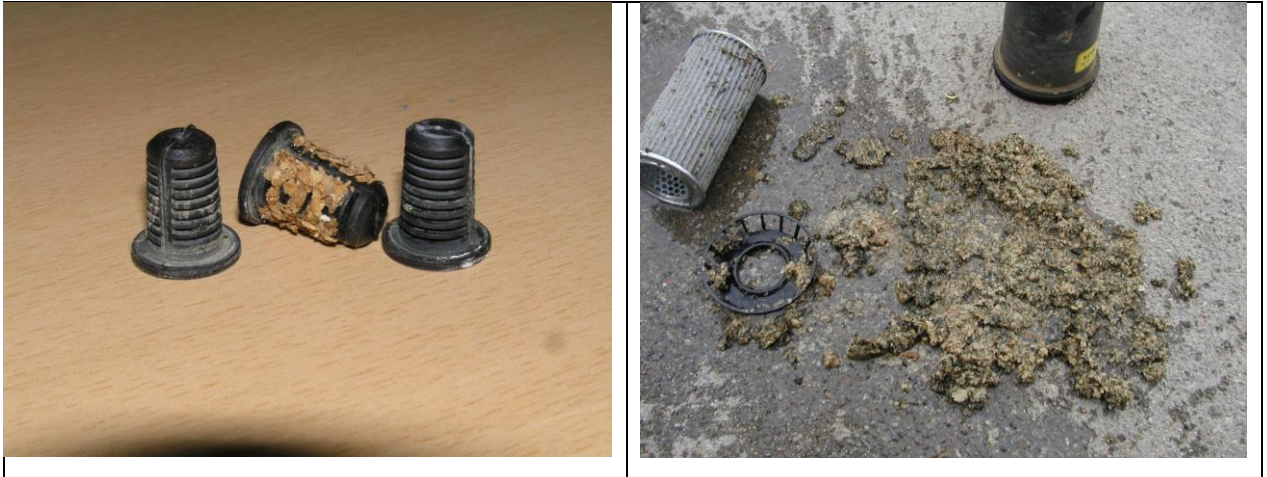
Slika 6. Nečistoće nakupljene u pročistaču
