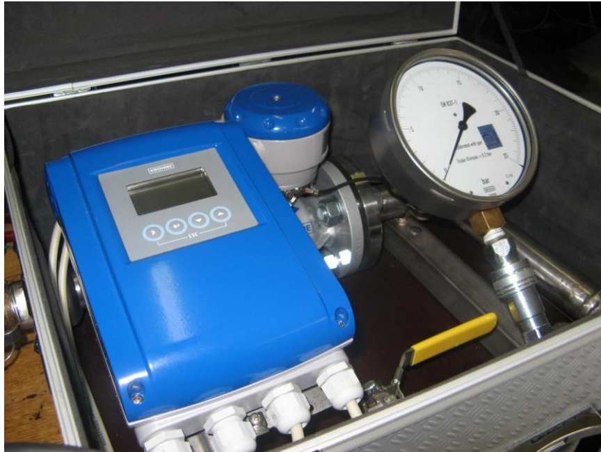
Slika 7. Mjerenje protoke crpke
