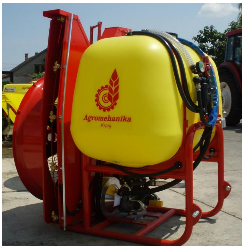
Slika 10. Traktorski nošeni raspršivač (Izvor: https://www.facebook.com/AgroForma/posts/atomizeri-agp-agromehanikaagp/ )
