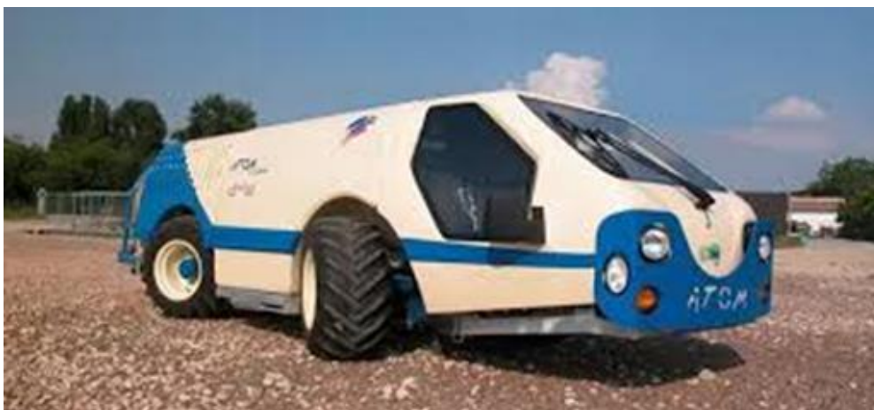
Slika 12. Samokretni atomizere ATOM 2000
