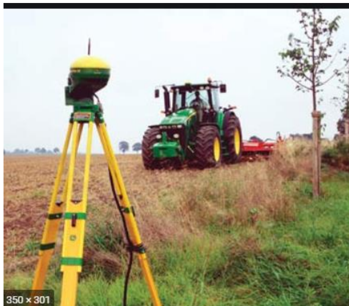
Slika 6. RTK bazna stanica
