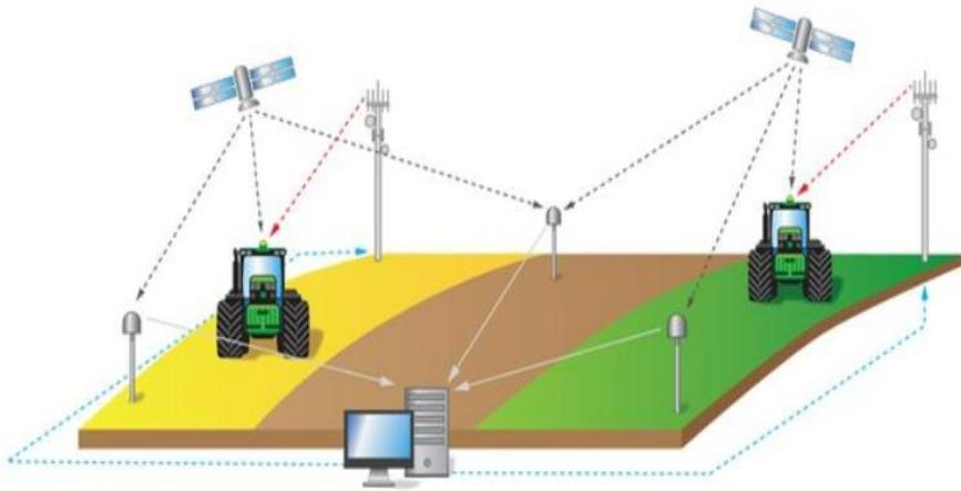
Slika 7. Primanje signala putem mobilnog RTK
