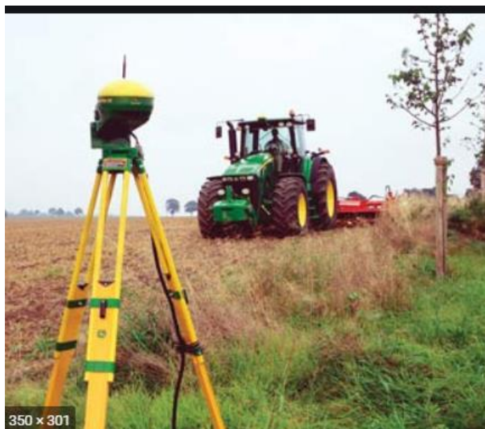
Slika 6. RTK bazna stanica
