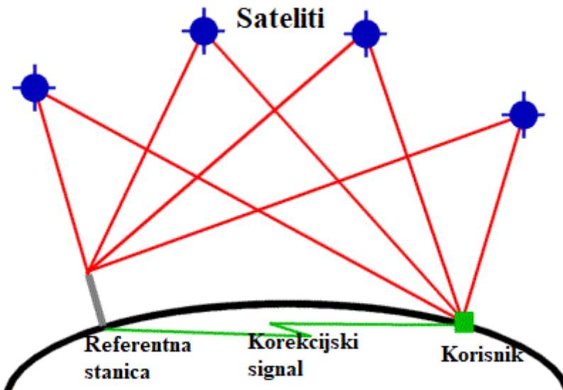
Slika 10. Princip rada diferencijalnog GNSS-a (Izvor: <http://www.beacon-egypt.com/dgps.htm>)
