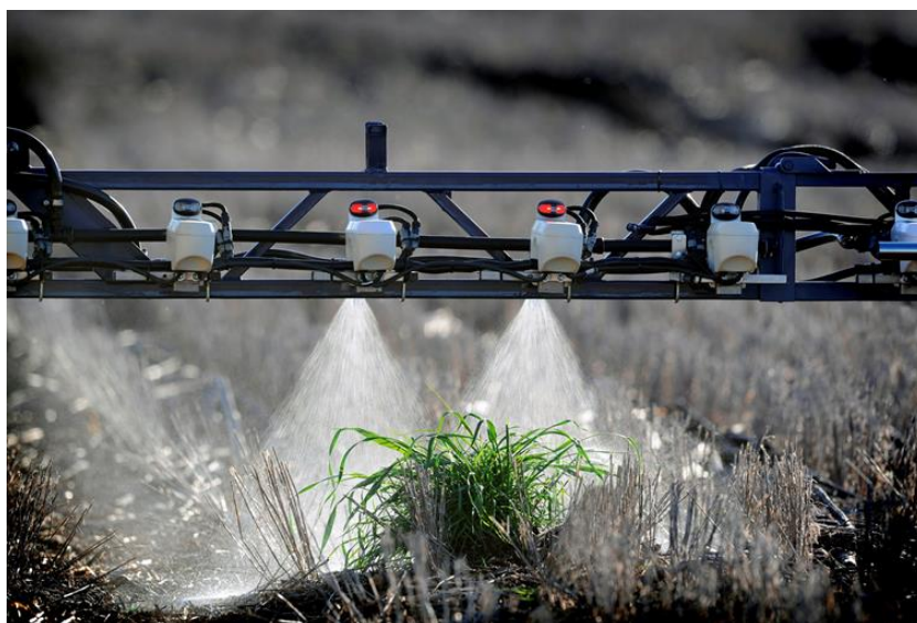
Slika 7. Prskalice opremljena sensorima korova (Izvor: https://www.weedsmart.org.au )
