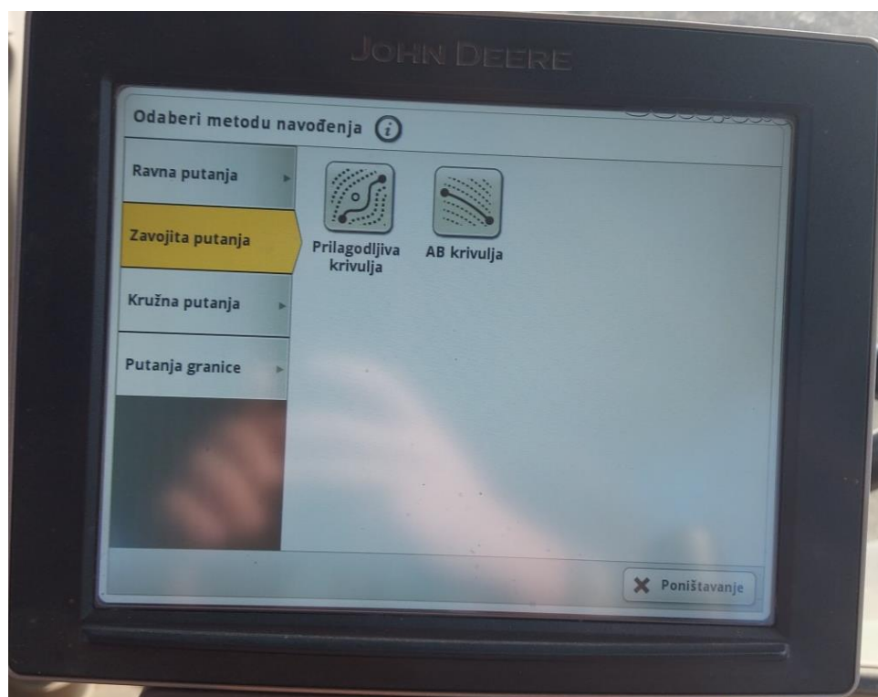
Slika 16. Metode navođenja za zavoјitu putanju (Izvor: vlastita fotografija)
