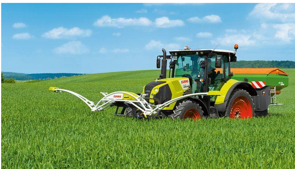
Slika 6. Traktor sa senzorom dušika (Izvor: https://amazone.net )
