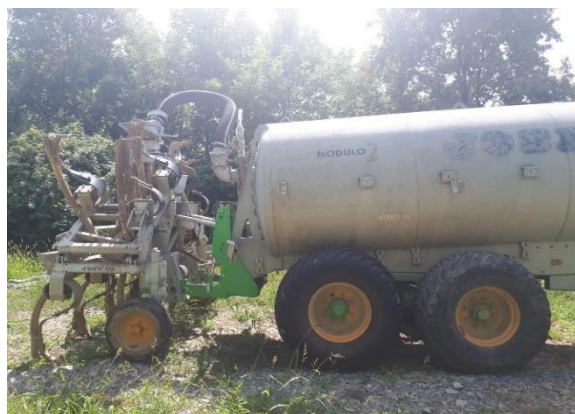
Slika 10: Cisterna s aplikatorom za gnojnicu
