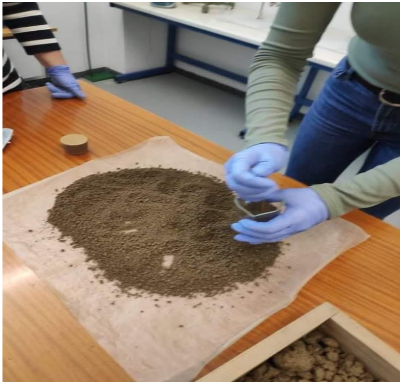
Slika 4. Odvajanje tla za uzorkovanje
