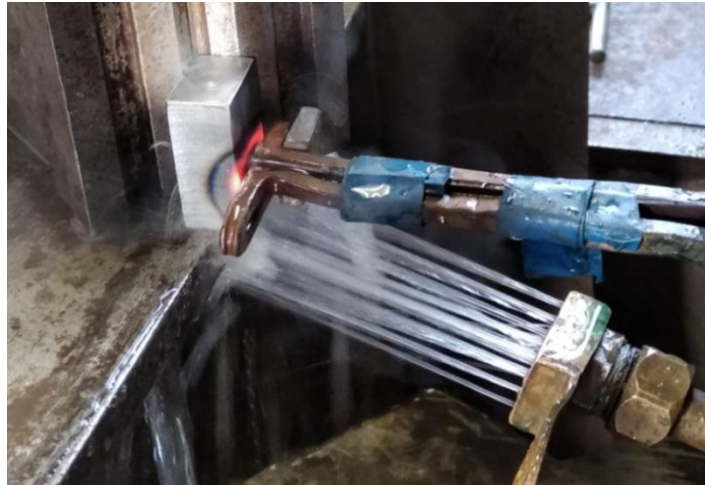
Slika 26. Indukcijsko površinsko kaljenje ispitnih uzoraka čelika 42CrMo4 (Izvor: Šalov, 2021.)
