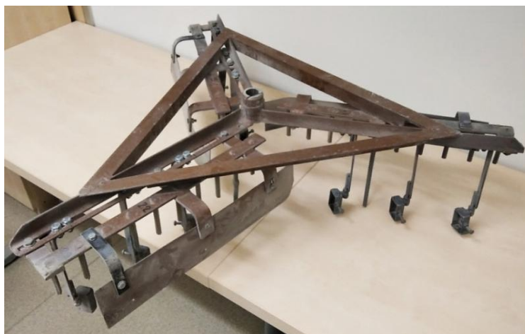
Slika 19. Trokraki nosač uzoraka s držačima uzoraka za ispitivanje trošenja (Izvor: Šalov, 2021.)
