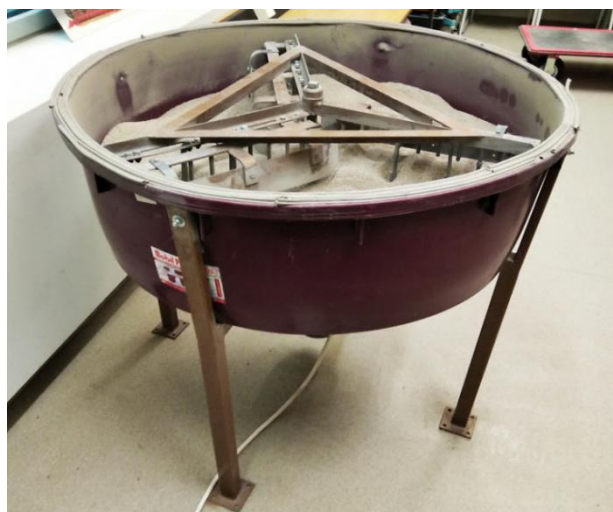
Slika 18. Radni dio uređaja za ispitivanje trošenja gibanjem uzoraka u masi abraziva (Izvor: Šalov, 2021.)
