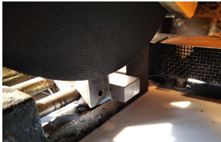
Slika 28. Rezanje uzoraka čelika 42CrMo4 reznom pločom (Izvor: Šalov, 2021.)
