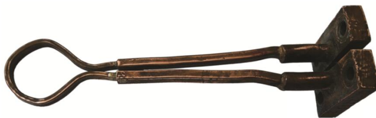
Slika 4. Jednovojni induktor (svitak)
