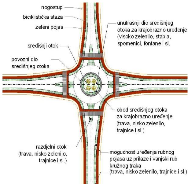
Sl. 23) Tlocrt kružnog toka s mogućim smjernicama krajobraznog uređenja unutar urbane sredine
