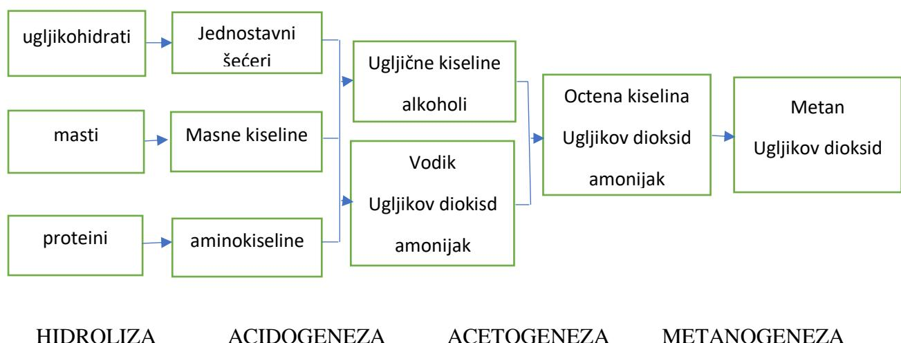
Slika 3. Shematski prikaz četiri faze anaerobne digestije
