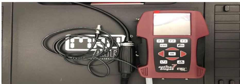
Slika 22. Prijenosni analizator bioplina
