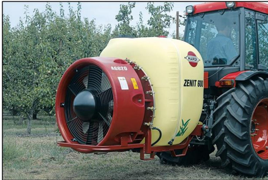
Slika 10. Traktorski nošeni raspršivač s aksijalnim ventilatorom
