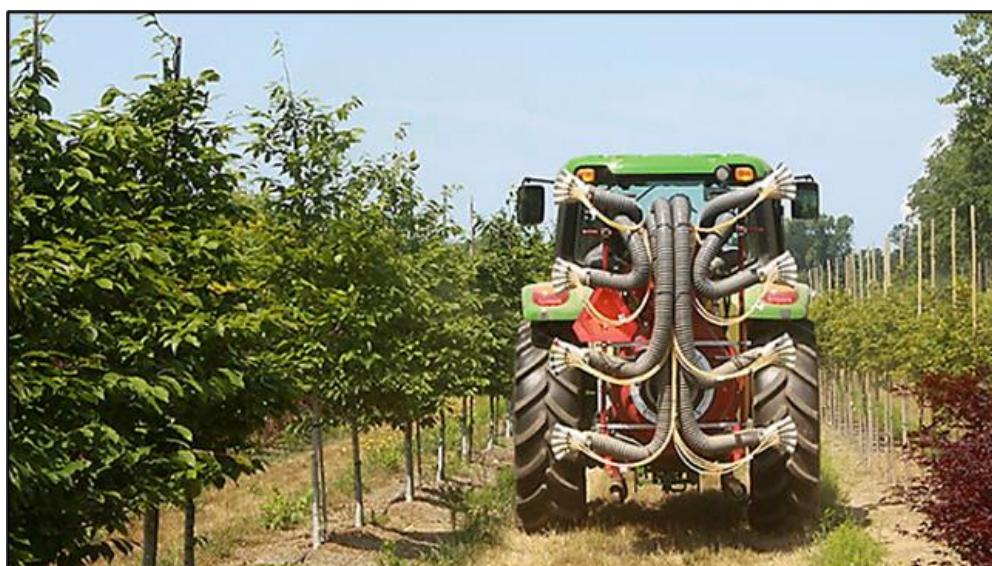
Slika 14. Raspršivač sa laserski senzorom za navođenje mlaza
