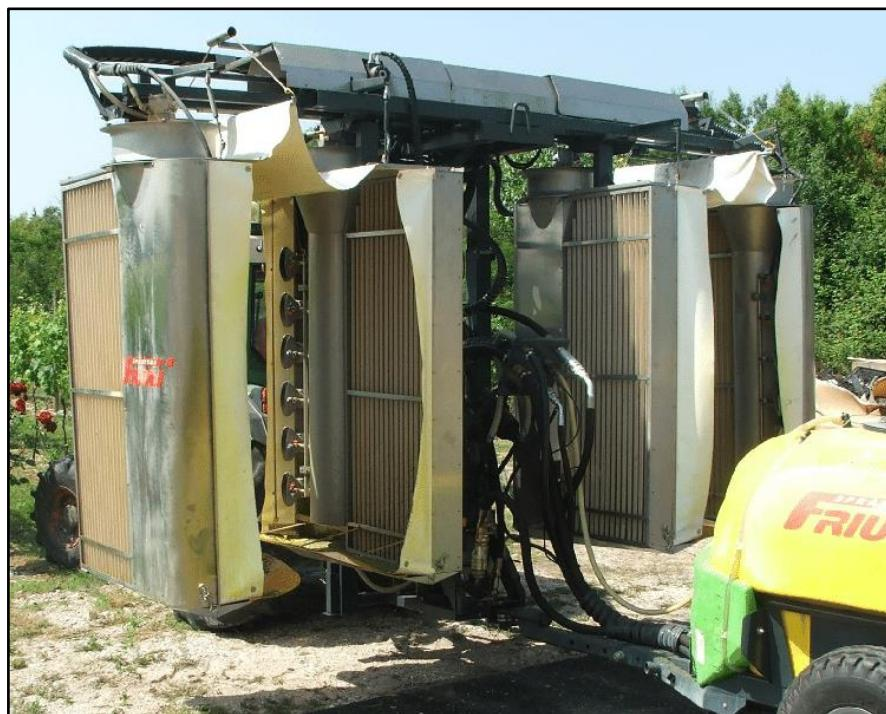
Slika 13. Tunelski raspršivač
