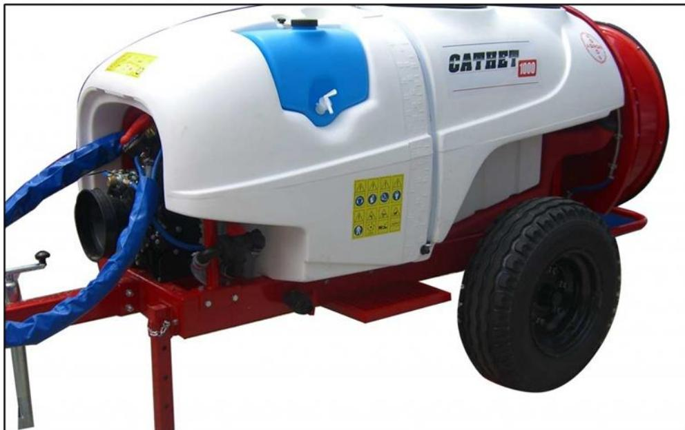
Slika 1. Spremnik raspršivača
