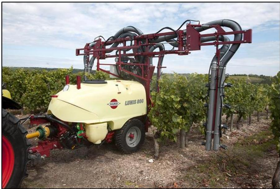
Slika 11. Traktorski vučeni raspršivač s radijalnim ventilatorom
