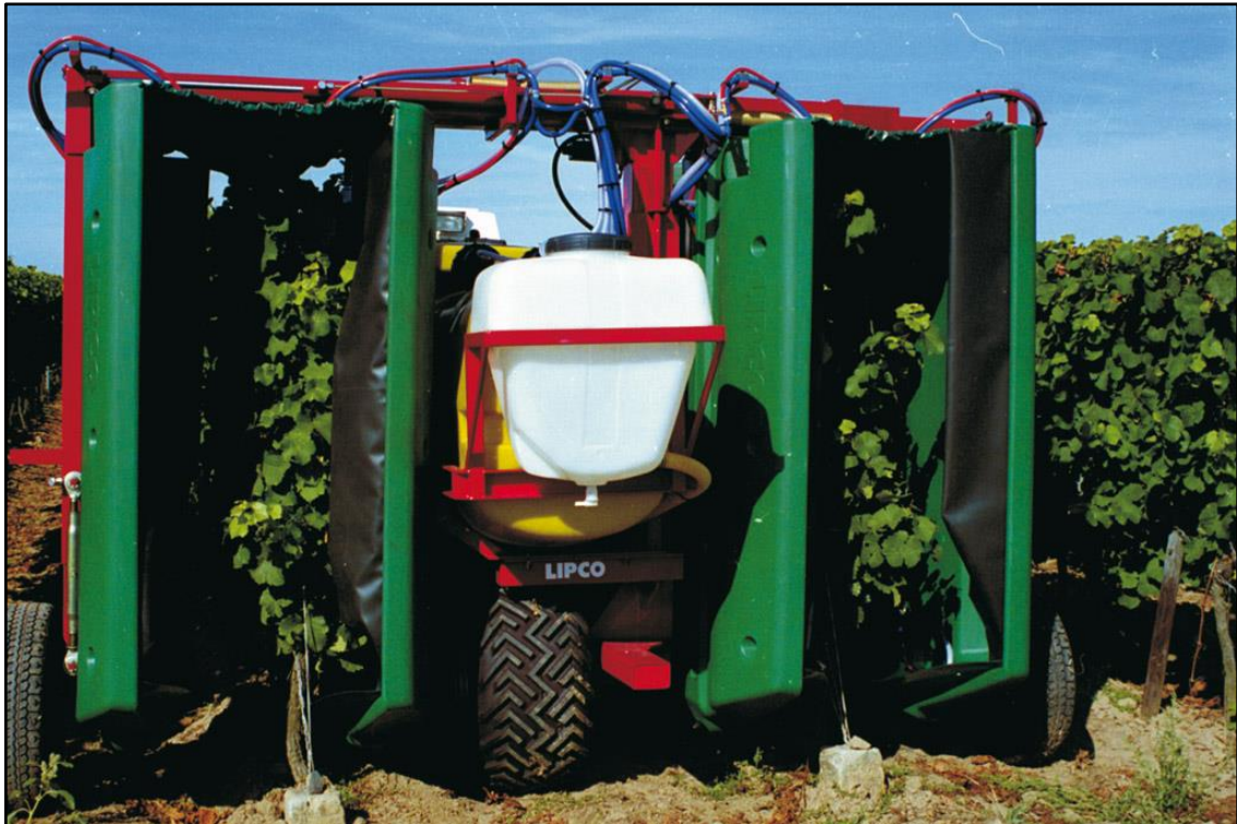
Slika 18. Raspršivač sa reciklirajućim sustavom
