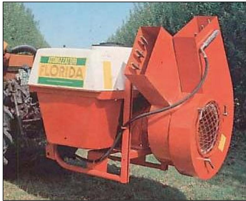
Slika 9. Radijalni ventilator
