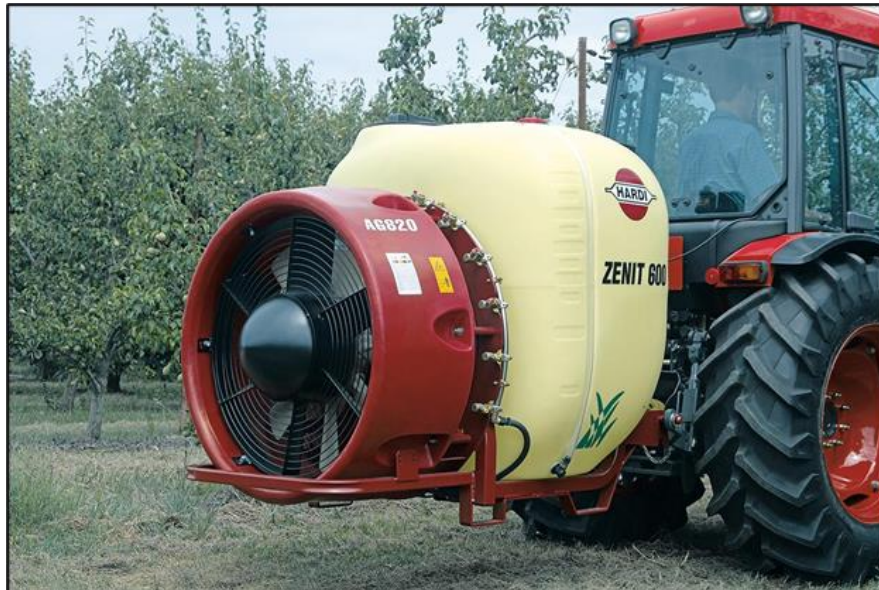
Slika 10. Traktorski nošeni raspršivač s aksijalnim ventilatorom
