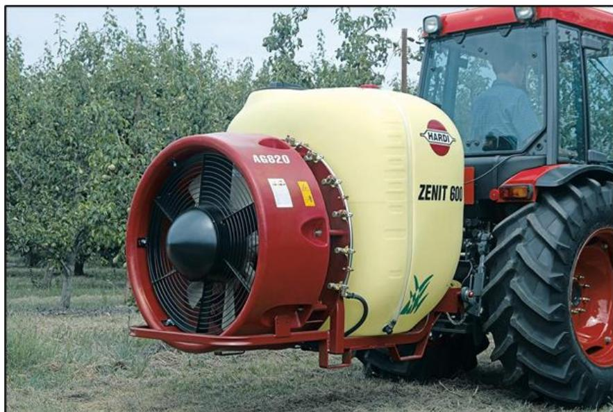
Slika 10. Traktorski nošeni raspršivač s aksijalnim ventilatorom
