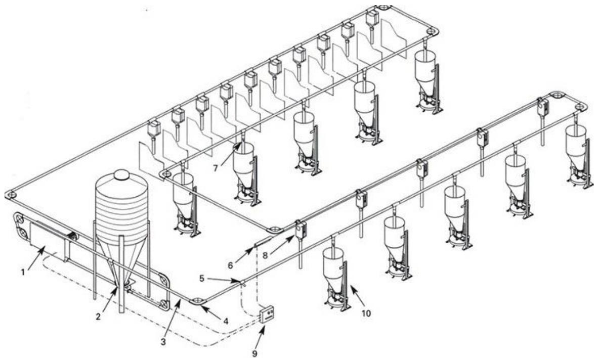
**Slika 11.** Oprema potreba na automatsku raspodjelu hrane (1=elektromotor, 2=silos, 3=cijev, 4=korner, 5=senzor, 6=sustav automatskog ispuštanja hrane, 7=sustav kapanja hrane, 8=senzor za doziranje hrane, 9=kutija za pokretanje sustava, 10=hranilica)
