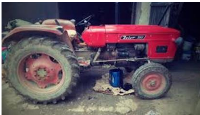
Slika 2. Ispuštanje motornog ulja u posudu
