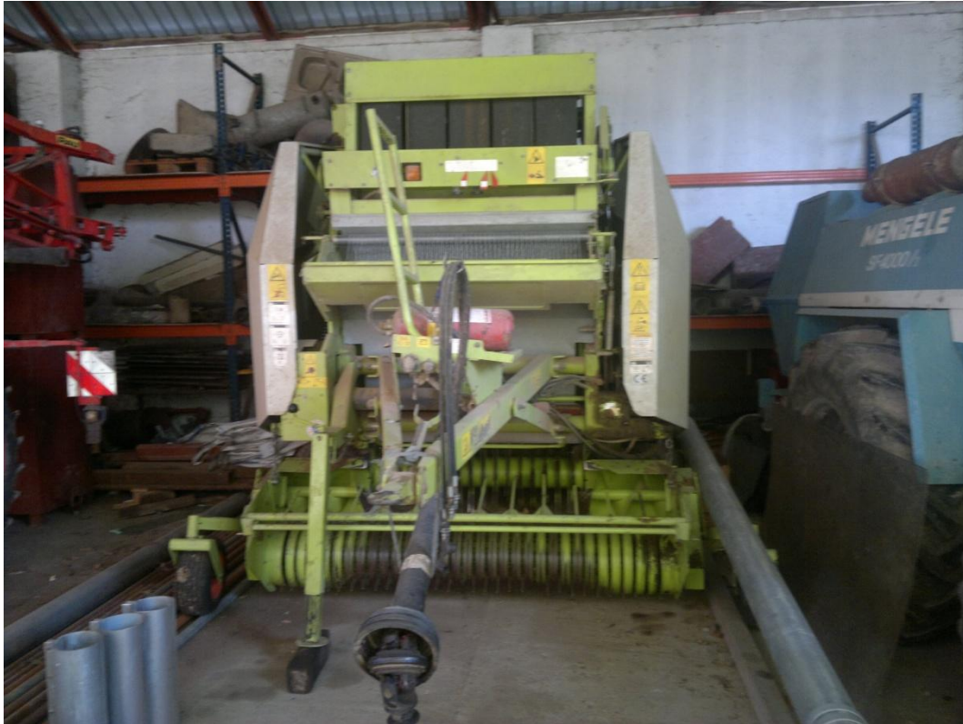
Slika 13. Rolo preša u zatvorenom prostoru
