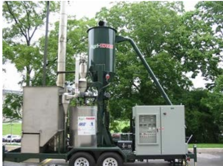
Slika 6. Prikaz pokretne jedinice za sporu pirolizu
