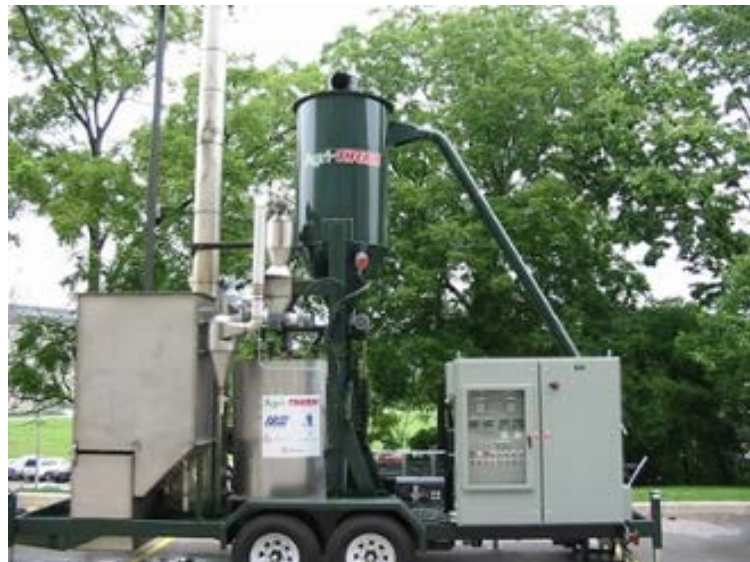
Slika 6. Prikaz pokretne jedinice za sporu pirolizu
