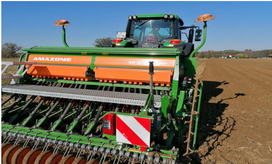
Slika 12. Sjetva pšenice sijačicom „Amazone AD 3000 super“
