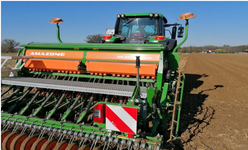
Slika 12. Sjetva pšenice sijačicom „Amazone AD 3000 super“
