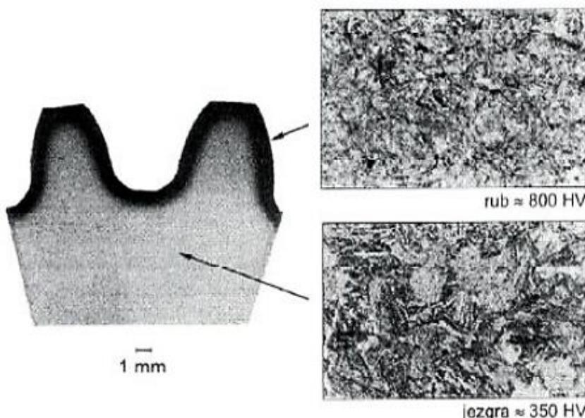
Slika 9. Mikrostruktura cementiranog zupčanika izrađenog iz čelika 16MnCr5
