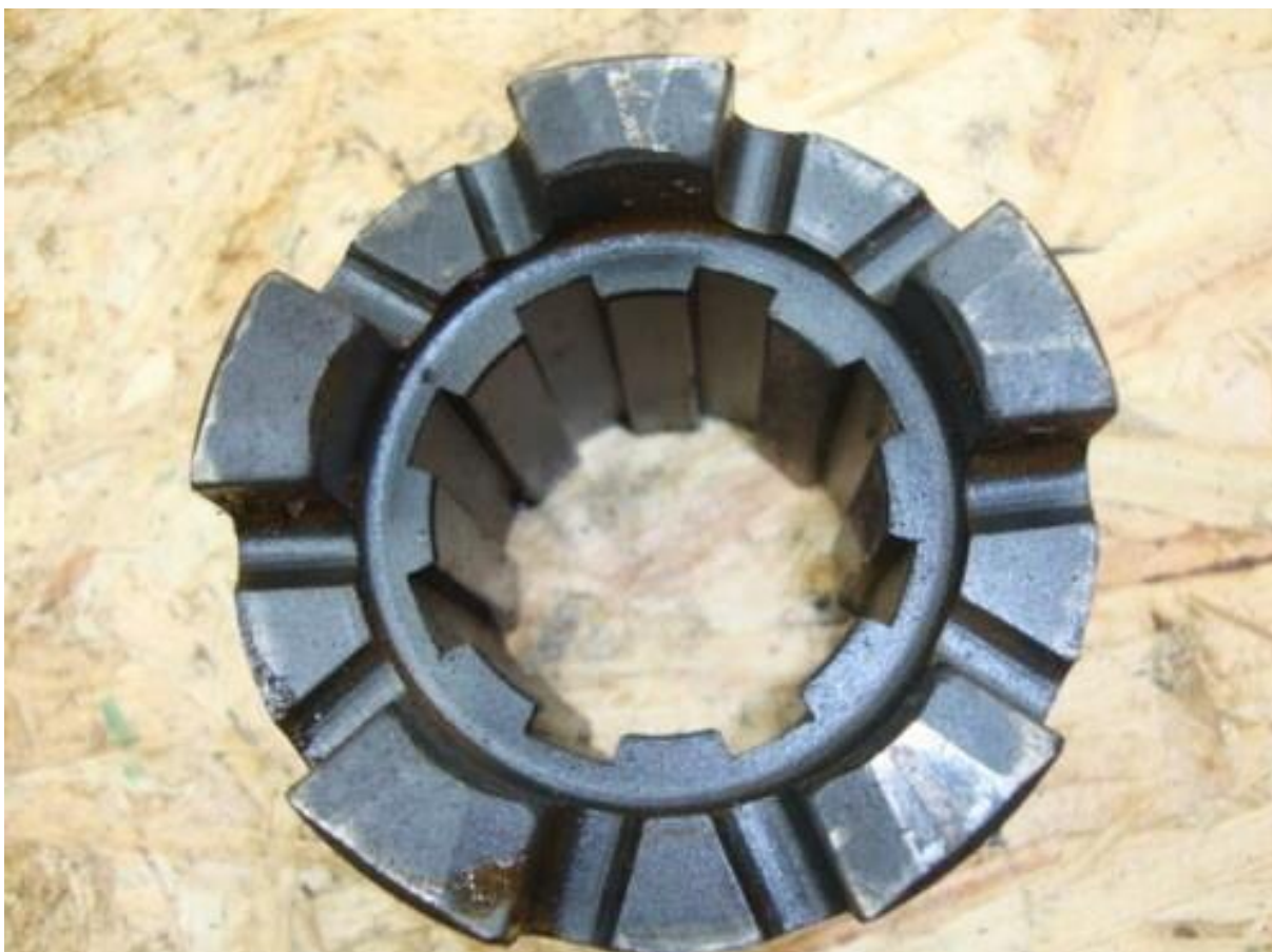
Slika 19. Primjena cementiranja na zupčaniku diferencijala traktora Fendt (Radić, 2021.)
