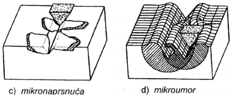
Slika 3. Shematski prikaz mikronaprsnuća i mikroumora (Izvor: Grilec i sur., 2015.)
