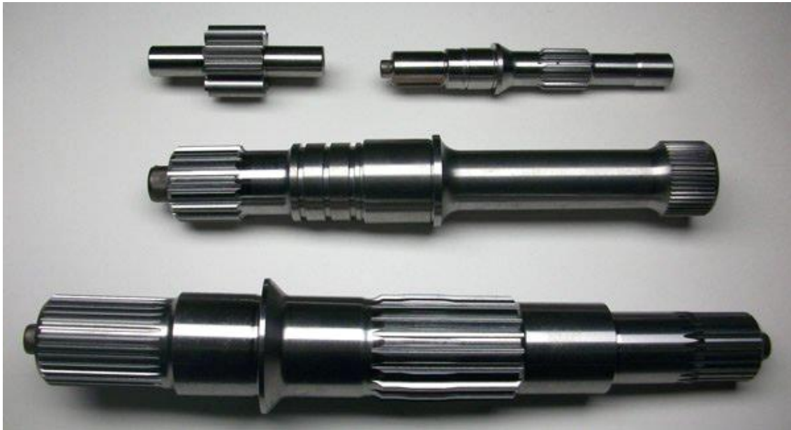
Slika 13. Primjena cementiranja na vratilima (Izvor: https://www.sst.net/service/casehardening/ )
