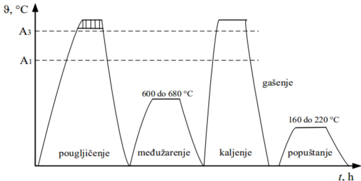
Slika 8. Dijagram postupka cementiranja (Izvor: Stupnišek i Cajner, 2001.).
