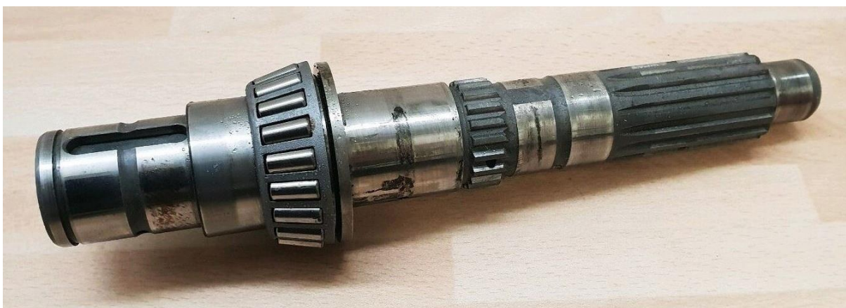
Slika 17. Primjena cementiranja na pogonskom vratilu traktora Fendt (Radić, 2021)
