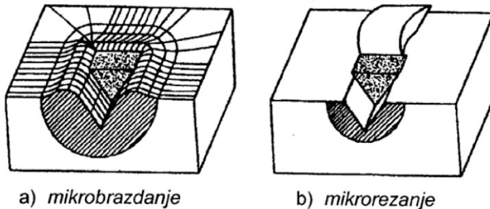
Slika 2. Shematski prikaz mikrobrzdanja i mikrorezanja (Izvor: Grilec i sur., 2015.)
