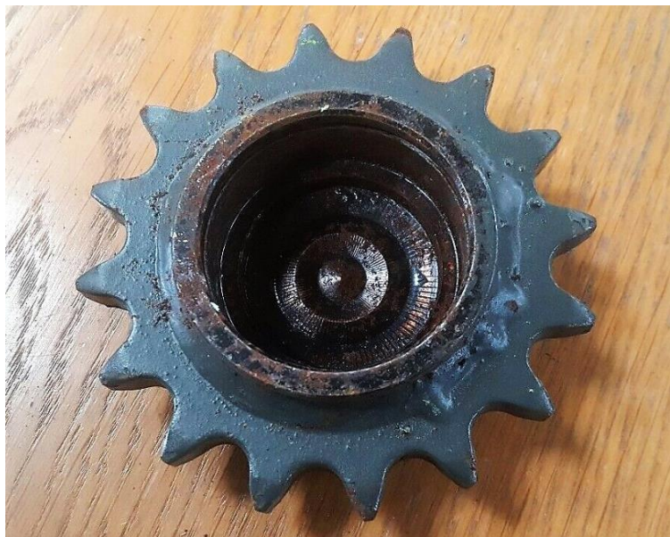
Slika 21. Primjena cementiranja na lančaniku hedera kombajna Claas (Radić, 2021.)
