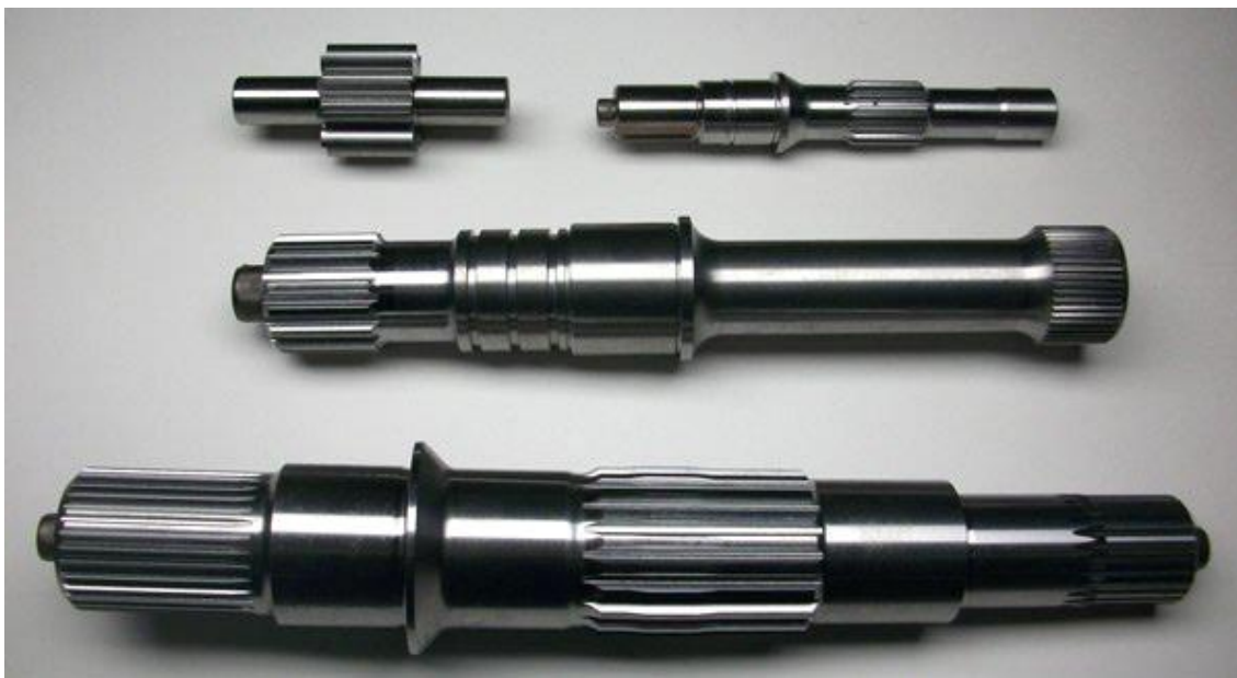
Slika 13. Primjena cementiranja na vratilima (Izvor: https://www.sst.net/service/casehardening/ )
