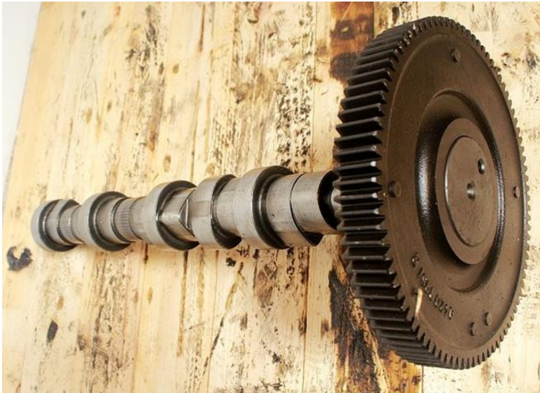
Slika 13. Bregasto vratilo traktora Fendt (Fotografija: Šakota, 2021.)
