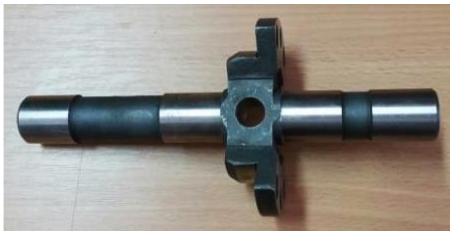
Slika 15. Vratilo diferencijala motokultivatora Goldoni (Fotografija: Šakota, 2021.)
