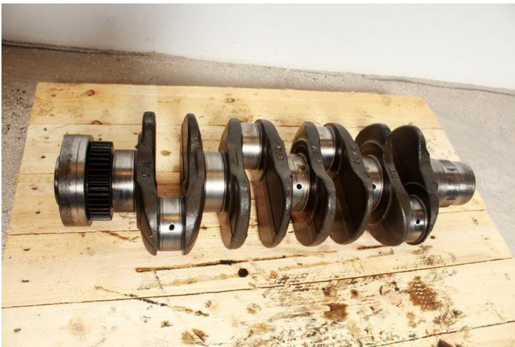
Slika 14. Koljenasto vratilo traktora Fendt (Fotografija: Šakota, 2021.)
