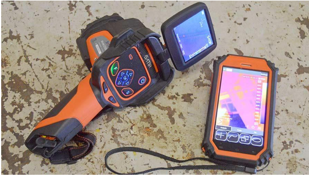
Slika 4. Prikaz infracrvene kamere
