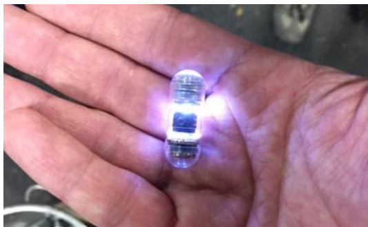
Slika 3. ALICAM bežična kapsula za endoskopiju
