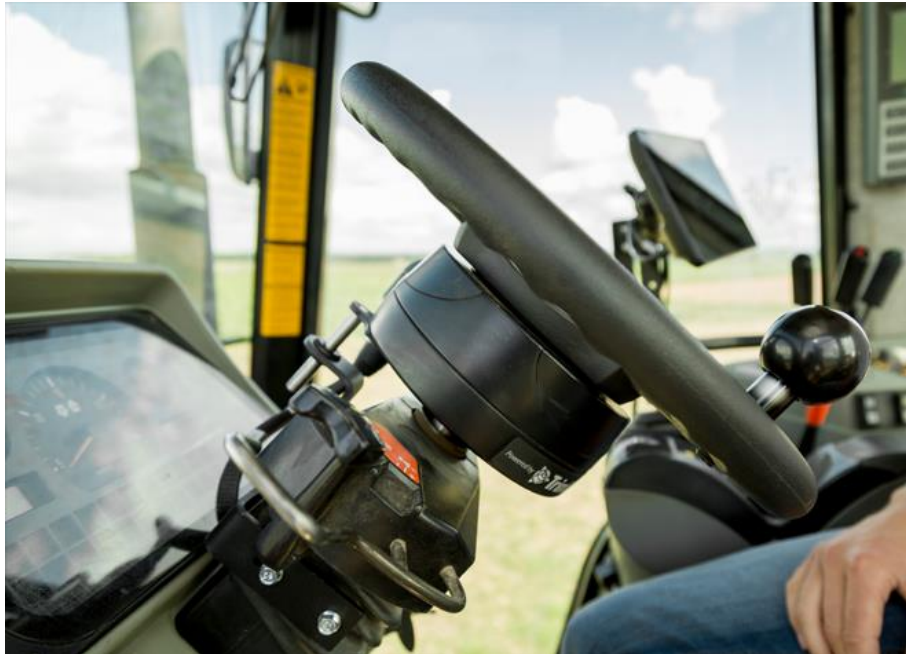
Slika 13. Trimble profesionalni sustav za navođenje (Izvor: https://agriculture.trimble.com/product/ez-pilot-pro-guidance-system/ )
