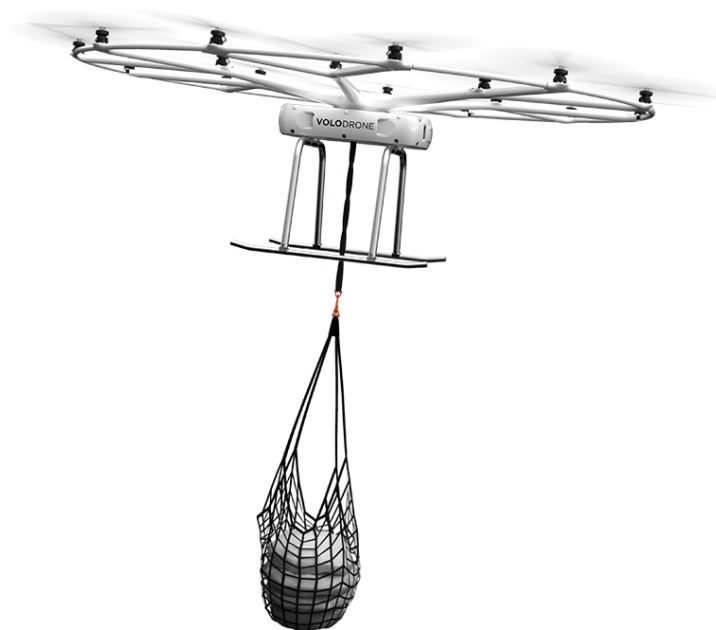
Slika 15. VoloDrone za prijevoz manjeg tereta ( https://www.volocopter.com/solutions/volodrone/ )
